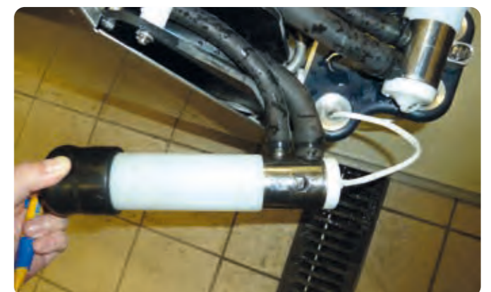
Bild 7: Belüftungslöcher am Melkbecher (siehe unteres Becherdrittel)
