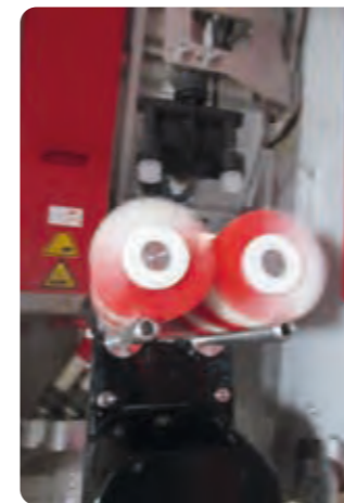
Bild 3 (links): Rotation der Bürsten entlang Abstreiferrohren zur Entfernung der Restfeuchtigkeit
