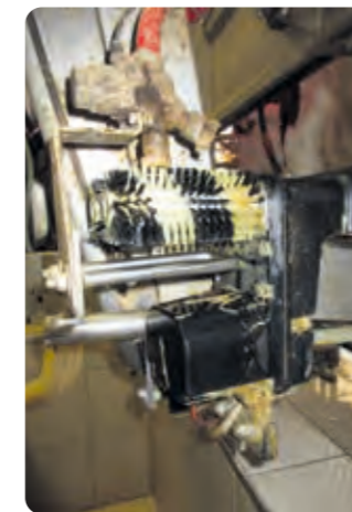
Bild 4: System, bei dem der Kontakt der Bürsten zu den Abstreiferrohren nicht mehr gegeben ist und die Hygiene der Düsen für die Bürstendesinfektion optimiert werden muss
