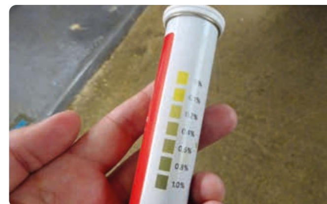
Bild 6: Teststreifen – hier zur Kontrolle der Konzentration der Lösung zur nasschemischen Desinfektion der Bürsten
